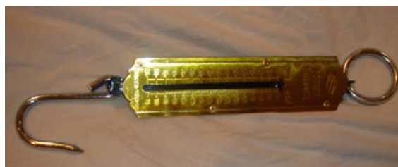
Figur 10. Exempel på fjädervåg. Denna går till max 75 kg (750N)
