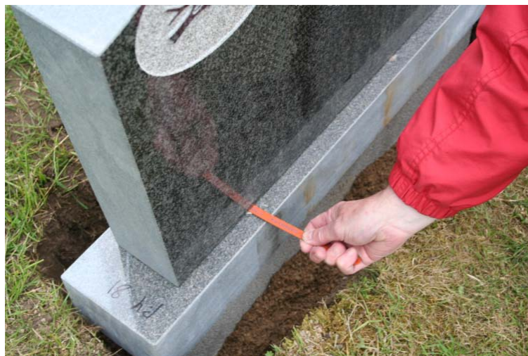
Figur 8. Kontroll av antalet dubbar med bågfilmsblad
