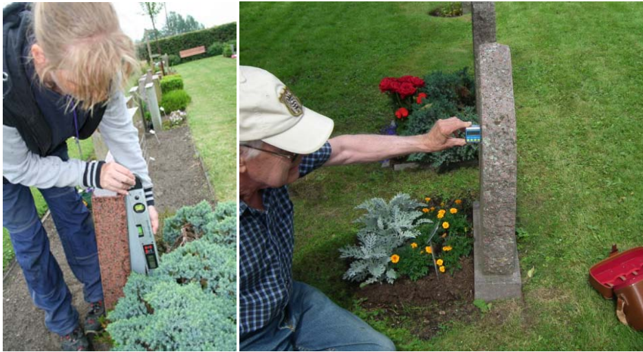
Figur 4. Kontroll av lutning med vinkelindikator.
